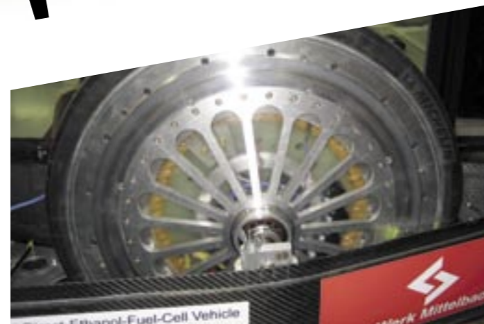
Das Hinterrad ist der Clou: Hier versteckt sich der strombetriebene Motor des Flitzers
